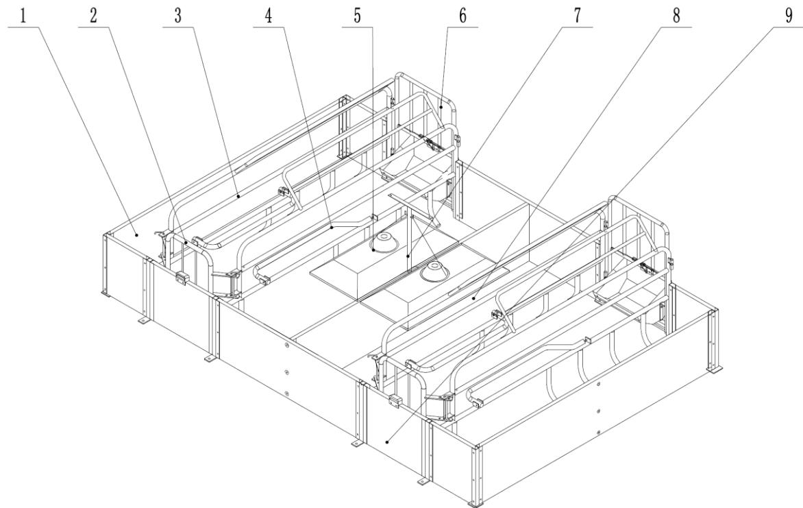
1-PVC围板；2-后门；3-左右栏片；4-防压杆；5-保温罩；6-前门；
